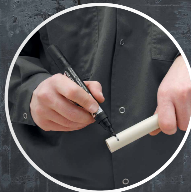
03 Metināšanas dziļuma atzīmēšana.
