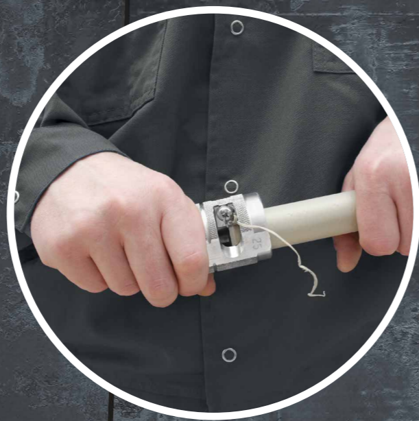
02 Alumīnija folijas noņemšana ar skrāpjiem (stabiAL PPR kompozītmateriāla caurules).
