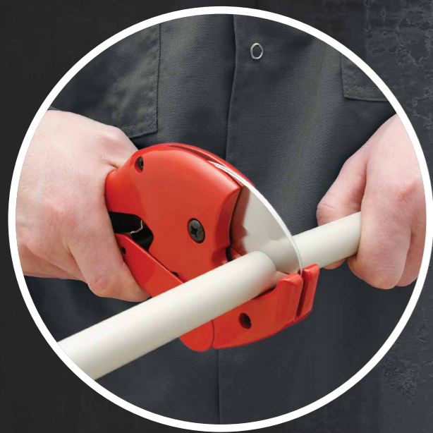
01 Cauruļu griešana ar šķērēm.
