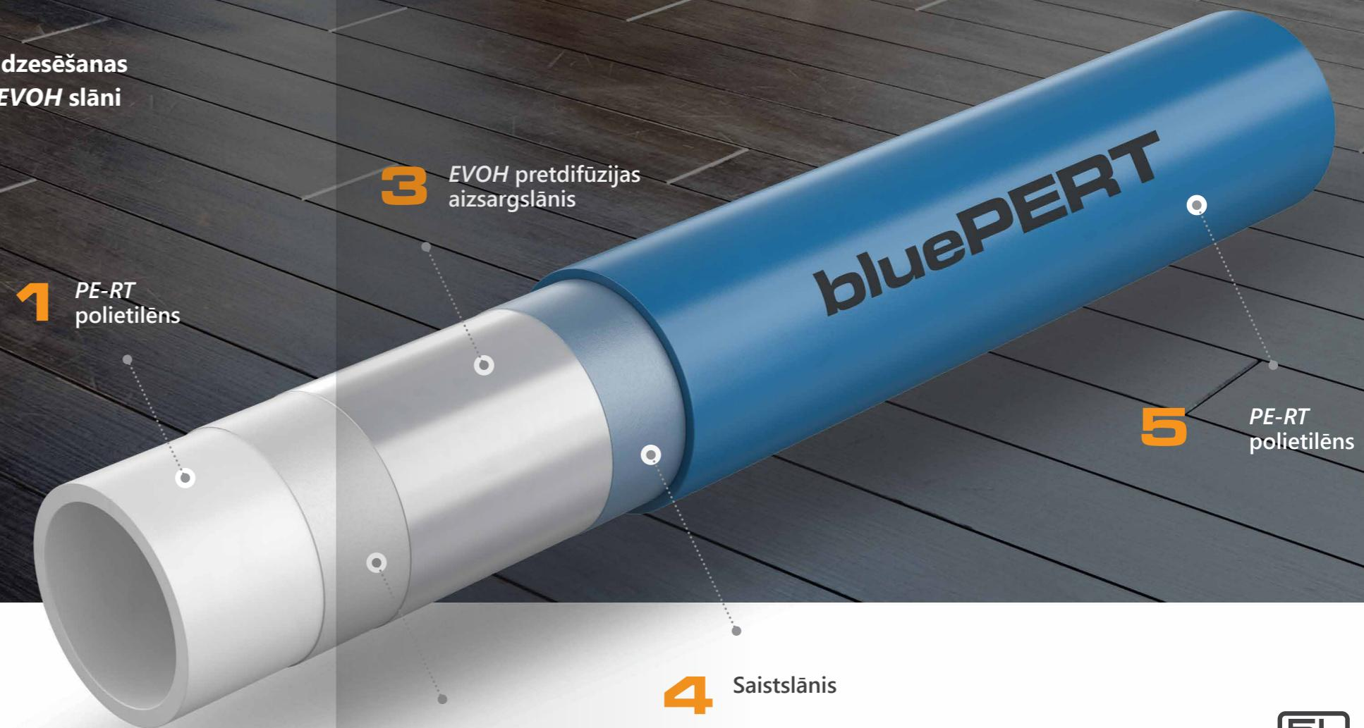
Augstas kvalitātes caurules ar *EVOH* pretdifūzijas aizsargslāni ir paredzēti virsmas apsildes un dzesēšanas sistēmu konstruēšanai (4. piemērošanas klase atbilstoši standartam ISO 10508).
