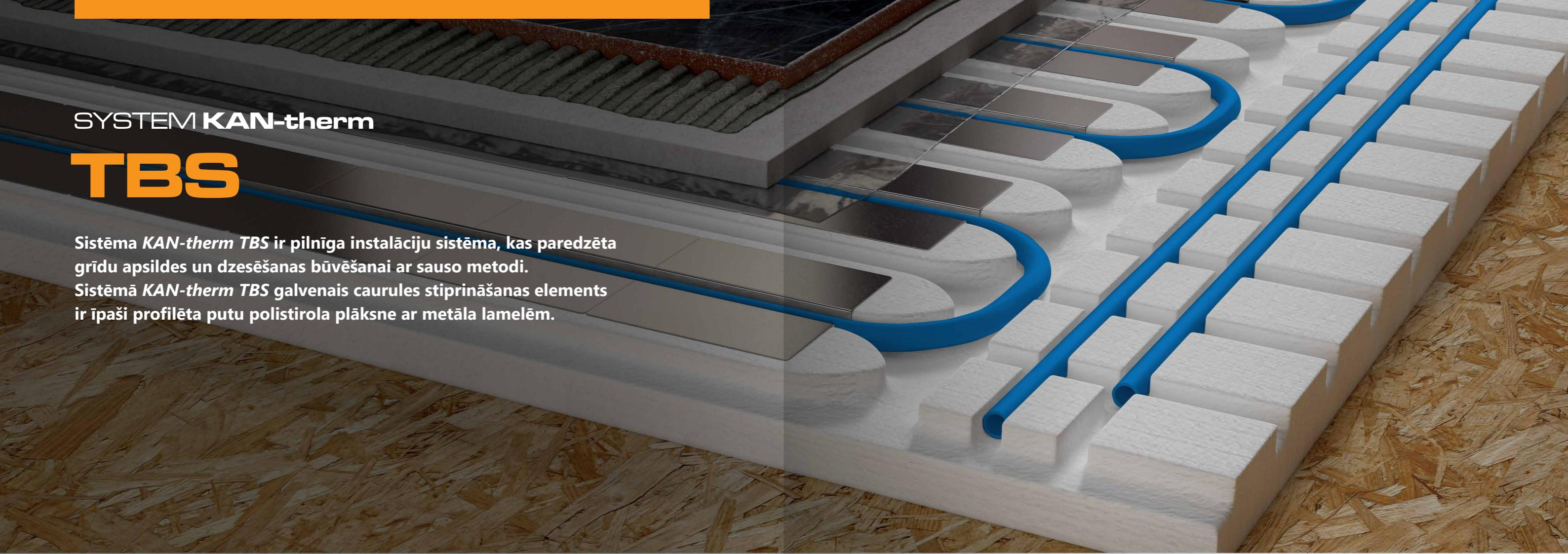
Ūdens grīdas apsildes sistēma, kas balstās uz sistēmas **KAN-therm TBS** plāksnēm, pieder pie grīdas apsildes konstrukcijām, kas izveidotas sausajā sistēmā. Apsildes caurules ir novietotas īpaši profilētās, rievotās izolācijas plāksnes un pēc tam pārklāti ar sausā klona plāksnēm ar biezumu, kas atkarīgs no projektētas grīdas ekspluatācijas slodzes. Siltums no apsildes caurulēm tiek vienmērīgi nodota sausā klona plāksnēm caur tērauda lamelēm plākšņu rievās.
