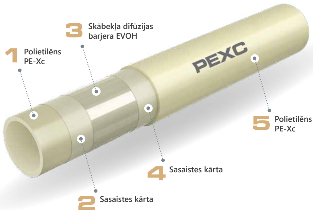
PEXC caurules ar pretdifūzijas pārklājumu šķērsriezuma skats
