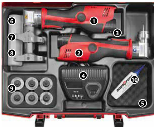
Komplekts ar presi, kas ir darbināma ar baterijām
