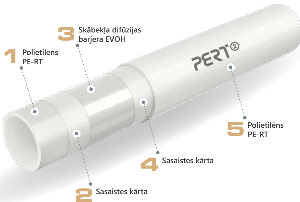
PEXC caurules ar pretdifūzijas pārklājumu šķērsriezuma skats
