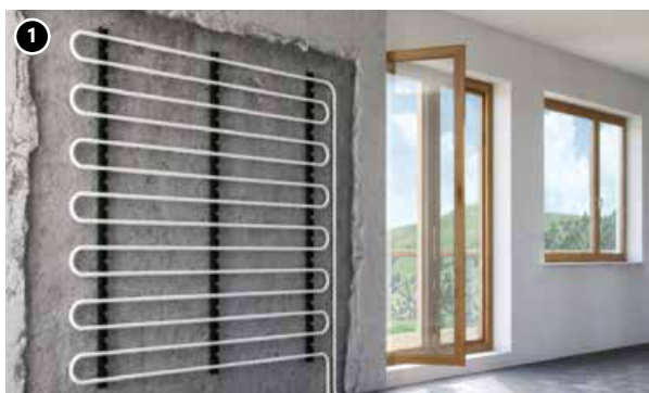
1. Sienas apsildes/dzesēšanas sistēma – A veida konstrukcija. 2. Sienas apsildes/dzesēšanas sistēma – B tipa konstrukcija.
