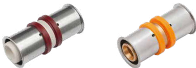
Att. 51. Savienotājs KAN-therm ultraPRESS PERTAL, PEXC, PERT, bluePERT un bluePERTAL caurulēm, 14 × 2, 16 × 2, 20 × 2, 25 × 2,5 mm.
