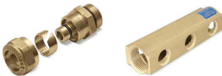
Pārejas savienojums ar 1/2" ārējo vītņi 16 × 2 mm cauruļu pievienošanai pie separatoriem.
